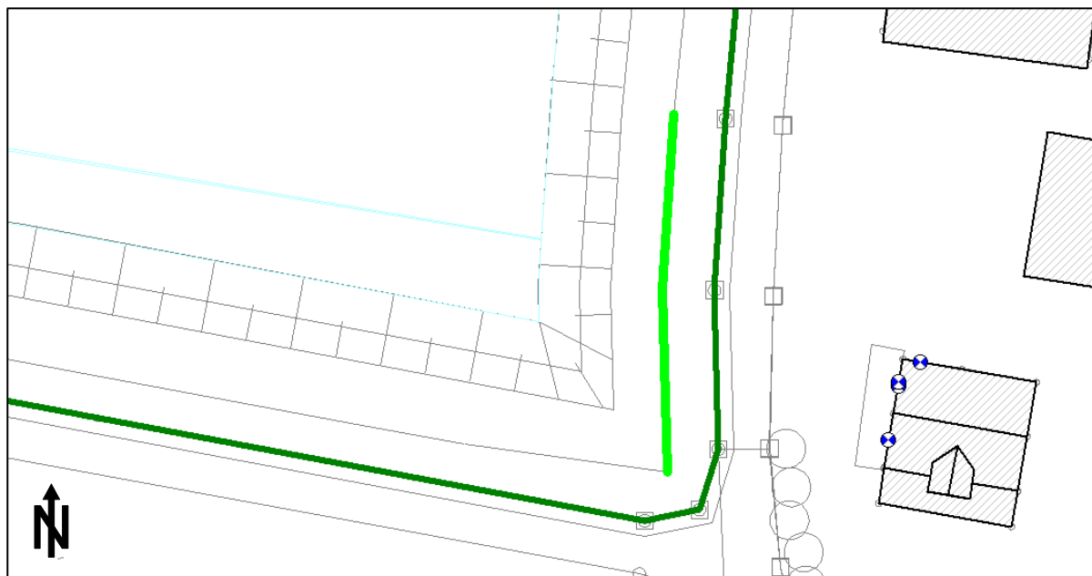
Abbildung 5 Digitale Flurkarte (c) mit Darstellung des Walls am Ostrand der Abbaufläche
